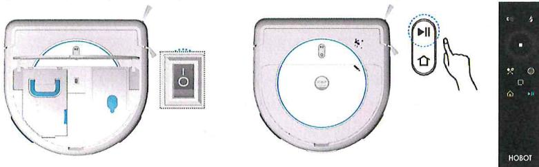
Если уборка началась не от зарядной станции, то установите устройство на пол в нужной комнате, на расстоянии 30-50см от пустого прямого участка стены, разместив передним бампером в сторону стены и нажмите
