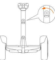
Поверните ручку регулировки высоты против часовой стрелки
