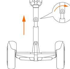
Поднимите коленные подушечки до нужной высоты. Поверните ручку регулировки высоты по часовой стрелке, чтобы затянуть
