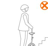
Поднимите стойку дополнительного управления, чтобы войти в режим энергосбережения (питание включено, управляющий сигвейем на нем не стоит). В данном режиме вы можете катить сигвей по гладким поверхностям. Не катите его вверх по лестнице, по выбоинам, по большим трещинам / неровным поверхностям или по другим препятствиям; направляйте свой MiniPro въезд препятствия или переносите его через препятствие, как показано в разделе транспортировки устройства.
