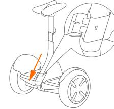
3 Плотно закройте защитную крышку рулевой стойки до щелчка
