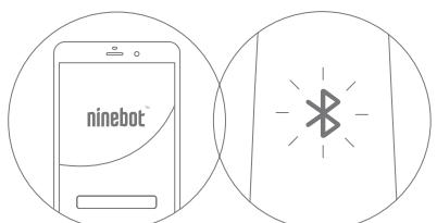
3 Нажмите на «Поиск новых устройств» и подключитесь к MiniPro. После успешного сопряжения устройств вы услышите звуковой сигнал сигвея, индикатор Bluetooth будет гореть постоянно.
