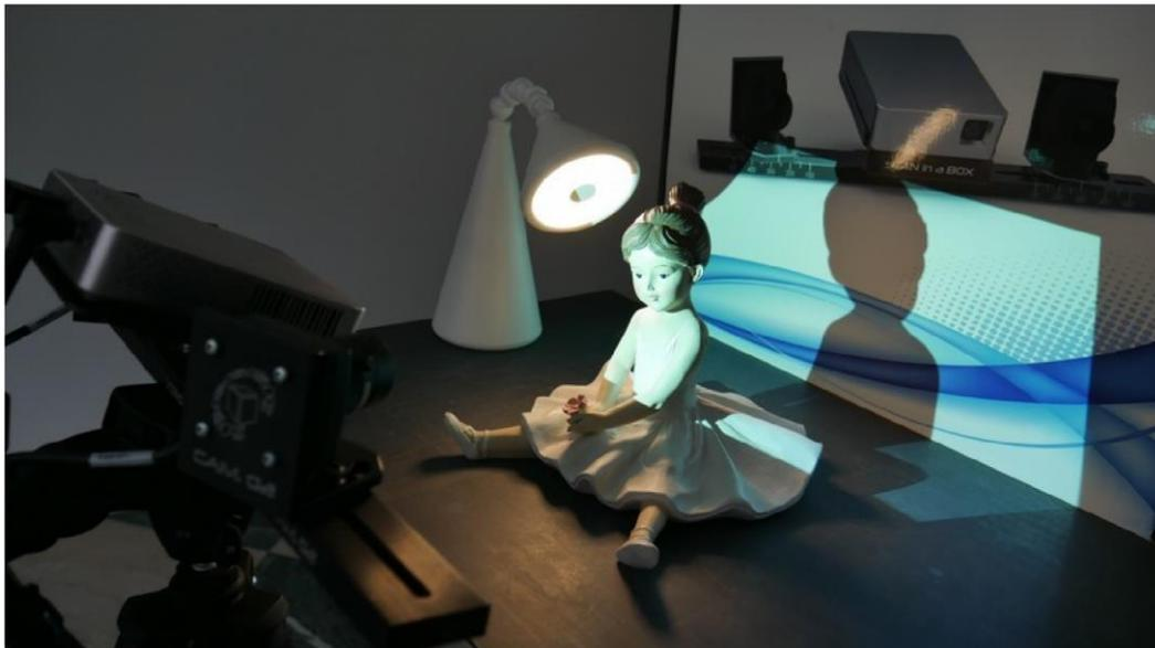
Рисунок 7: пример условий освещения, которых следует избегать: свет направлен непосредственно на объект
