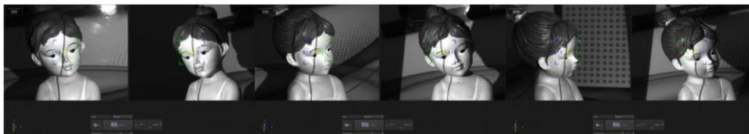
Рисунок 27: реальные виды прежних положений сканера. Следует иметь в виду, что жёлтое перекрестие всегда располагается над проецируемой вертикальной линией.
