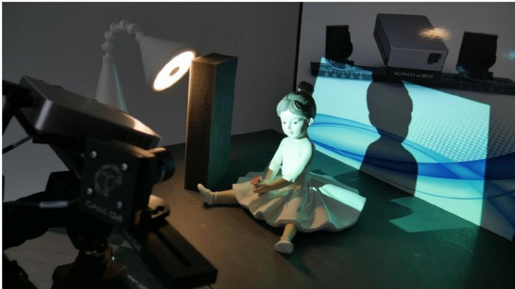
Рисунок 9: пример условий освещения, которых следует избегать: на объект проецируется тень
