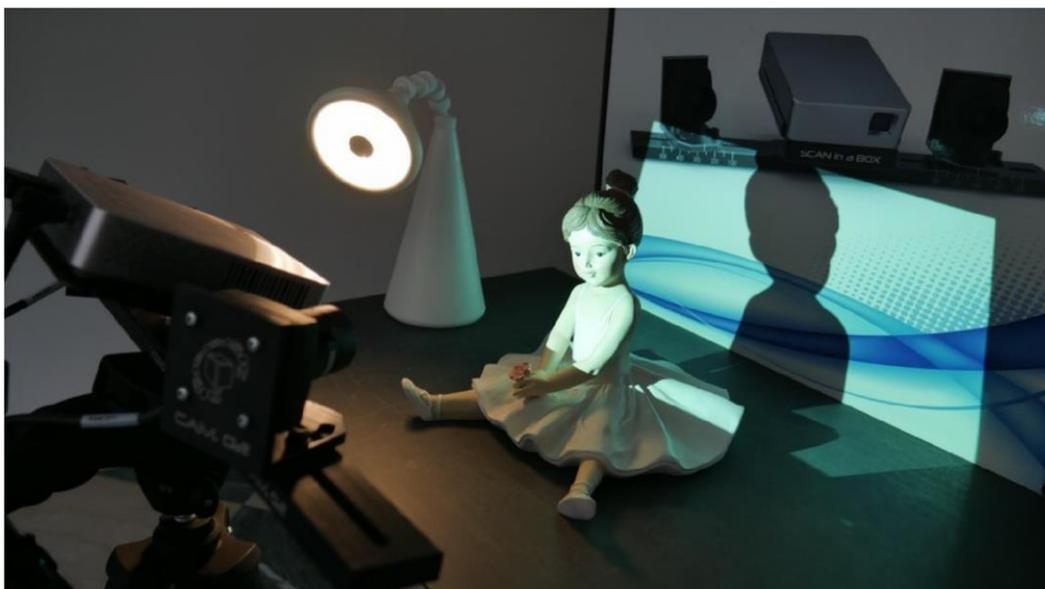
Рисунок 8: пример условий освещения, которых следует избегать: свет направлен непосредственно на сканер
