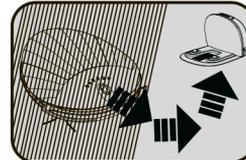
Устройство совершает поиск зарядной станции с помощью солнечного света, если устройство попадет в темное пространство и в течении 5 секунд не найдет сигнал станции, устройство автоматически произведет выключение.
