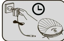
Первая зарядка или зарядка после длительного перерыва в использовании аккумуляторной батареи занимает 12 часов. Цикл полной разрядки-зарядки следует повторить 3-4 раза для последующей эффективной работы батареи.
